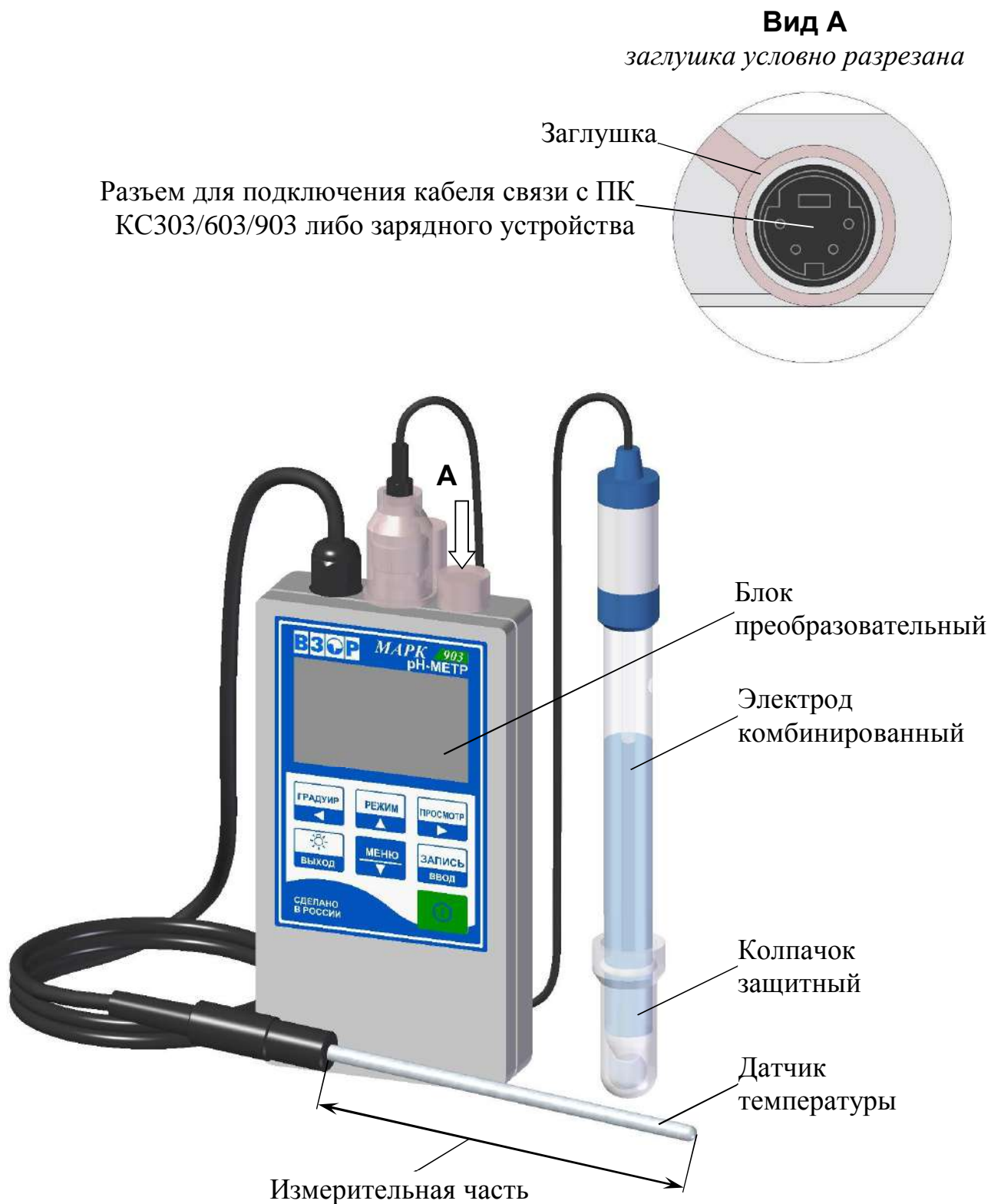
Рисунок 1.1 - рН-метр МАРК-903 (вид спереди)
