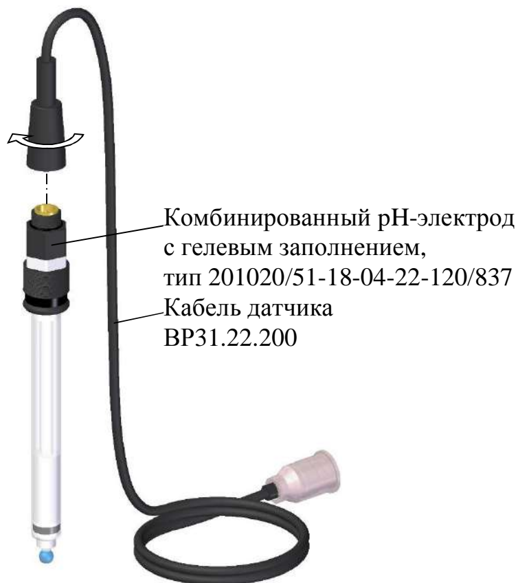
Рисунок 2.2 – Подсоединение кабеля датчика ВР31.22.200 к электроду
